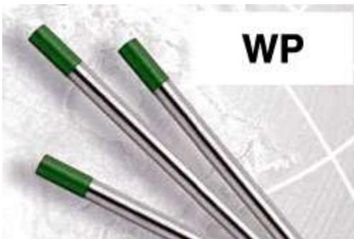
**Применение:** сварка алюминия (Al), магния (Mg) и его сплавов на переменном (AC) токе.
