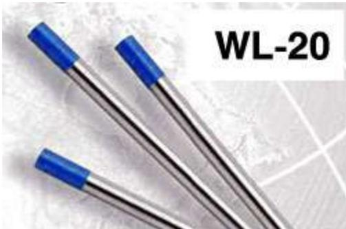
Лантановые электроды более долговечны и меньше загрязняют вольфрамом сварной шов. Оксид лантана равномерно распределен по длине электрода, что позволяет длительное время сохранять при сварке первоначальную заточку электрода. Это серьезное преимущество при работе на постоянном (прямой полярности) или переменном токе со сталью и нержавеющей сталью. При сварке на переменном синусоидальном токе рабочий конец электрода должен иметь сферическую форму.
