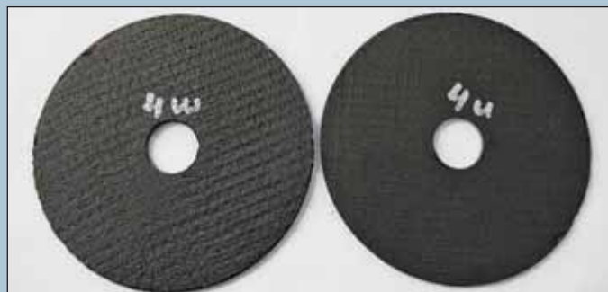
Слева — предположительная подделка, справа — образец, в происхождении которого мы уверены. Видно, что у левого образца армирование «какое-то не такое»... при внимательном исследовании становится понятно, что с этой стороны в нем не одна сетка, как должно быть, а сразу три
