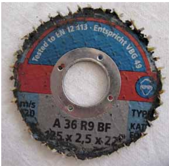
Примерно так выглядел круг толщиной 2,5 мм после попыток резать арматурный прут. Видны следы сильного бокового трения, да и режущая кромка явно в ненормальном состоянии — перегрета и обломана по кругу
