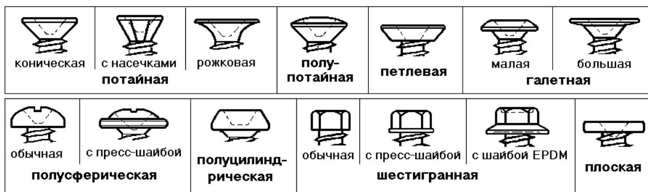
Рис.1. Типы головок шурупов и саморезов
