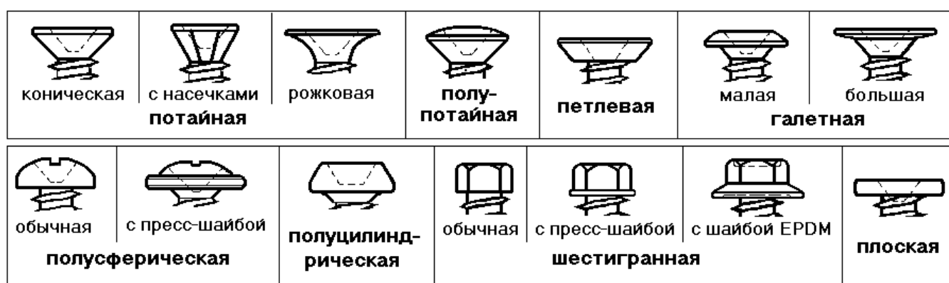
Рис.1. Типы головок шурупов и саморезов
